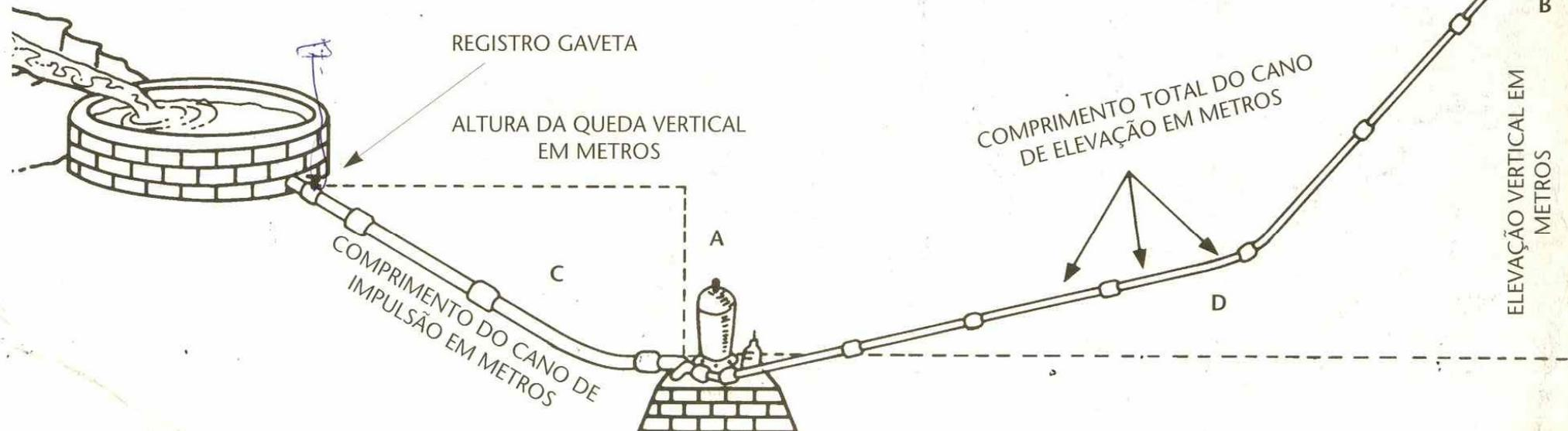
OBS.: O comprimento do cano de entrada d'água "C" deve ser aproximadamente igual a altura vertical da elevação "B", observando que o comprimento do cano de alimentação "C" deverá ser no mínimo 5 vezes a altura da queda "A". A disposição do cano "C" deve ser o mais reto possível. A perda de
